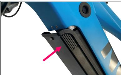
Schlüssel abziehen und Akku-Cover aufsetzen.
